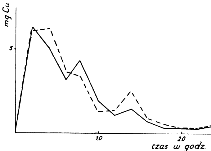
Wykres VI. Ilości wydzielonej Cu w poszczególnych dwugodzinnych okresach elektrodializy. Torf wysoki II — Braniewo.
